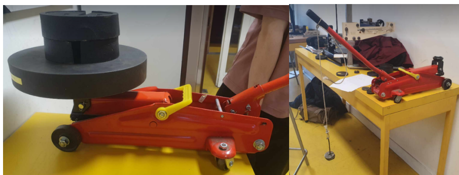
Figure 5 - Photos de l'expérience de détermination de la corrélation entre force utilisateur et charge sur la sellette soudée
