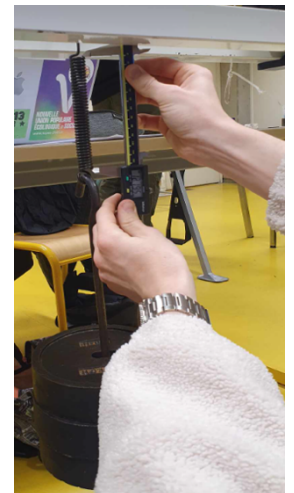
Figure 4 - Mesure de la longueur sous tension du ressort
