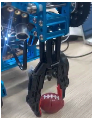
Figure 37 : Premier essai de récupération avec le système Pince au 15/11/2025
